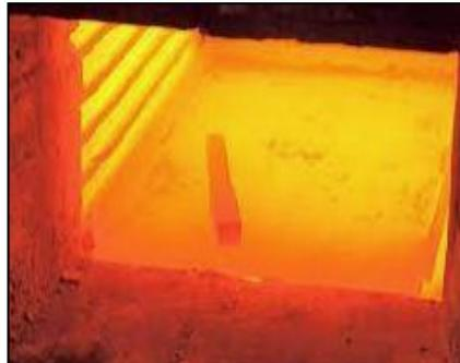
Gambar 4. Proses *Annealing*
